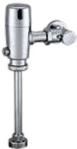
Fluxómetro electrónico a batería para urinario de 1 litro 2121V23012000 Tubo de descarga en acero inoxidable, descarga indirecta.
